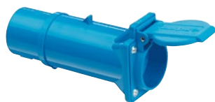
ADAPTER CEE-Stecker 3-pol., 16 A, 230 V, 6h blau auf Steckdose 1462052 mit Erdungssystem nach franzö- sisch/belgischer Norm und erhöhtem Berührungsschutz (Kinderschutz) spritzwassergeschützt IP44
