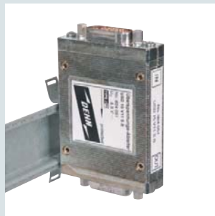
HutschieneMontage mittels Rastfuß. Die Ableitung von Überspannungen erfolgt über die Hutschiene.
