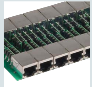
Variante mit beidseitig geschirmten RJ45-Buchsen.
