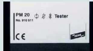
Geprüft werden kann das Ansprechverhalten von Gasentladungsableitern, Varistoren und Zenerdioden.
