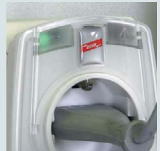
Optische Betriebs- und Defektanzeige der Energieseite.
