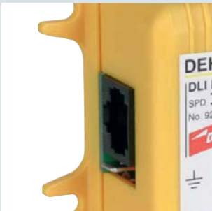
Einfache und schnelle Installation durch RJ-Steck-Anschlusstechnik.
