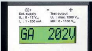
Anzeige der gemessenen Ansprechspannung.
