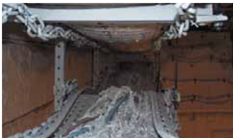
Die Testanordnung nach der Feuerprobe
