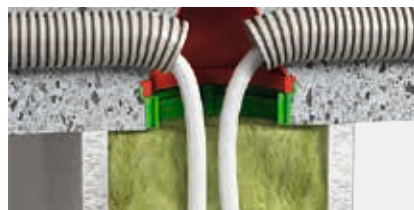
Die kleinen Deckendosen eignen sich z. B. als Kuppeldose für Zwischenwände.
