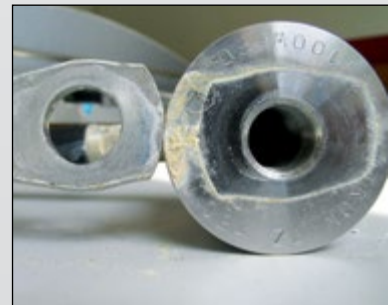
WEB 0 und Kabelschuh nach dem Salznebeltest
