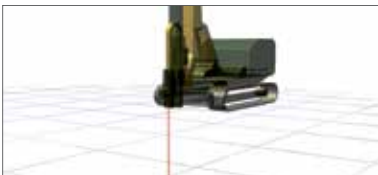
1. Bohren des Loches mit Kreuzbohrkrone
