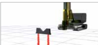
4. Aufbringen des Anprallschutzes
