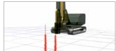
3. Bohren und Befüllen des zweiten Fundamentes
