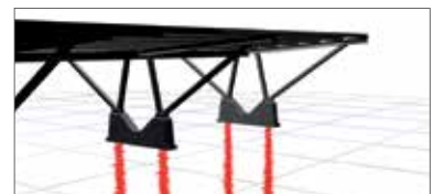
6. Fertigstellen der Trägerkonstruktion
