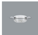
82936.000 Einbauring Zum bündigen Einbau für Leuchten mit Deckenausschnitt \varnothing 131mm. Kunststoff, weiß (RAL9002). Befestigung für Deckenstärken 12,5-25mm. Die Einbautiefe der Leuchte erhöht sich um 2mm. Gewicht 0,1kg
