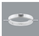
82939.000 Einbauring Zum bündigen Einbau für Leuchten mit Deckenausschnitt \varnothing 240mm. Kunststoff, weiß (RAL9002). Befestigung für Deckenstärken 12,5-25mm. Die Einbautiefe der Leuchte erhöht sich um 2mm. Gewicht 0,25kg
