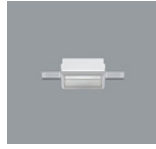
82920.000 Einbaurahmen Zum bündigen Einbau für Leuchten mit Deckenausschnitt 104x104mm. Kunststoff, weiß (RAL9002). Befesti- gung für Deckenstärken 12,5-25mm. Die Einbautiefe der Leuchte erhöht sich um 2mm. Gewicht 0,15kg
