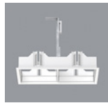
83968.000 Einbaurahmen 2fach Kunststoff, weiß (RAL9002). Werkzeug- lose Befestigung für Deckenstärken 1-30mm. Überdeckendes Einbaudetail. Einbautiefe 260mm für Richtstrahler und Einbautiefe 220mm für Downlights und Einbaustrahler. Gewicht 0,3kg
