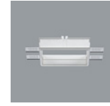
82922.000 Einbaurahmen Zum bündigen Einbau für Leuchten mit Deckenausschnitt 168x168mm. Kunststoff, weiß (RAL9002). Befesti- gung für Deckenstärken 12,5-25mm. Die Einbautiefe der Leuchte erhöht sich um 2mm. Gewicht 0,2kg
