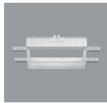
82923.000 Einbaurahmen Zum bündigen Einbau für Leuchten mit Deckenausschnitt 206x206mm. Kunststoff, weiß (RAL9002). Befesti- gung für Deckenstärken 12,5-25mm. Die Einbautiefe der Leuchte erhöht sich um 2mm. Gewicht 0,3kg
