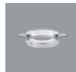
82937.000 Einbauring Zum bündigen Einbau für Leuchten mit Deckenausschnitt \varnothing 168mm. Kunststoff, weiß (RAL9002). Befestigung für Deckenstärken 12,5-25mm. Die Einbautiefe der Leuchte erhöht sich um 2mm. Gewicht 0,15kg
