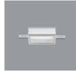
82921.000 Einbaurahmen Zum bündigen Einbau für Leuchten mit Deckenausschnitt 133x133mm. Kunststoff, weiß (RAL9002). Befesti- gung für Deckenstärken 12,5-25mm. Die Einbautiefe der Leuchte erhöht sich um 2mm. Gewicht 0,15kg
