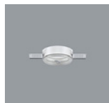
82935.000 Einbauring Zum bündigen Einbau für Leuchten mit Deckenausschnitt \varnothing 104mm. Kunststoff, weiß (RAL9002). Befestigung für Deckenstärken 12,5-25mm. Die Einbautiefe der Leuchte erhöht sich um 2mm. Gewicht 0,1kg
