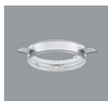
82938.000 Einbauring Zum bündigen Einbau für Leuchten mit Deckenausschnitt \varnothing 206mm. Kunststoff, weiß (RAL9002). Befestigung für Deckenstärken 12,5-25mm. Die Einbautiefe der Leuchte erhöht sich um 2mm. Gewicht 0,2kg
