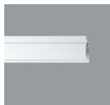
78350.000 Einputzprofil Aluminiumprofil, silber eloxiert. Zur deckenbündigen Montage von Stromschienen in Putzdecken. B 40mm, H 52mm, L 3000mm. Gewicht 3kg
