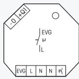
**1 Schließer nicht potenzialfrei 600 VA und 1-10 V-Steuerausgang 40 mA. Stand-by-Verlust nur 1 Watt. Dimmgeschwindigkeit einstellbar. Mit Kinderzimmer- und Schlummerschaltung. Mit Taster- oder Schalter-Ansteuerung.**
