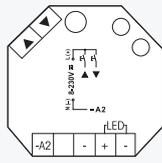
**Power MOSFET für LED-Lampen 12-36V DC bis 4 A, Pulsweiten-Modulation PWM. Stand-by-Verlust nur 0,1 Watt. Mindesthelligkeit und Dimmgeschwindigkeit einstellbar. Mit Kinderzimmer- und Schlummerschaltung.**
