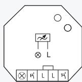
**Ohne N-Anschluss, Power MOSFET bis 400W. Stand-by-Verlust nur 0,5 Watt. Mit Steuereingängen für Lichttaster und Lichtschalter. Mindesthelligkeit und Dimmgeschwindigkeit einstellbar.**
