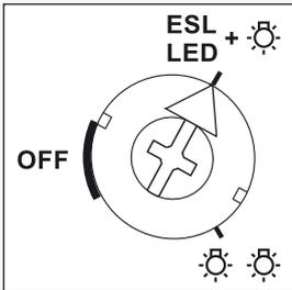
Diese Einstellung muss bei ESL und 230 V-LED-Lampen auf der Frontseite eingestellt werden, wenn der Universal-Dimmerschalter in den Comfort-Einstellungen ESL oder LED betrieben wird. Auch bei Leistungserhöhung mit zusätzlichen Leuchten.
