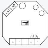
**DC-Konstantstromquelle für LED bis 1000 mA bzw. 30 Watt. Stand-by-Verlust nur 0,1 Watt. Mindesthelligkeit und Dimmgeschwindigkeit einstellbar. Mit Kinderzimmer- und Schlummerschaltung.**
