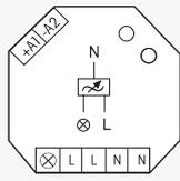
**Universal-Dimmerschalter. Power MOSFET bis 400W. Automatische Lampenerkennung. Stand-by-Verlust nur 0,1 Watt. Mindesthelligkeit einstellbar. Mit Kinderzimmer- und Schlummerschaltung.**
