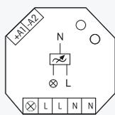
**Universal-Dimmerschalter. Power MOSFET bis 400 W. Automatische Lampenerkennung. Stand-by-Verlust nur 0,1 Watt. Mindesthelligkeit oder Dimmgeschwindigkeit einstellbar. Mit Kinderzimmer- und Schlummerschaltung.**
