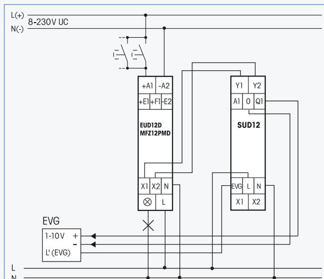
In dieser Schaltungsart können, in Verbindung mit einem Universal-Dimmerschalter EUD12D bzw. MFZ12PMD elektronische Vorschaltgeräte und Trafos mit einer 1-10V-Schnittstelle bis zu 40 mA Gesamt-Steuerstrom angesteuert werden.
