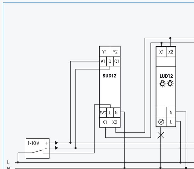
In dieser Schaltungsart kann, in Verbindung mit einem an die Anschlüsse X1/X2 angeschlossenen Leistungszusatz LUD12, der Ausgang eines 1-10V-Steuergerätes an A1/O in eine direkte Dimmfunktion umgesetzt werden. Das Ein- und Ausschalten erfolgt ebenfalls extern an L des SUD12.
