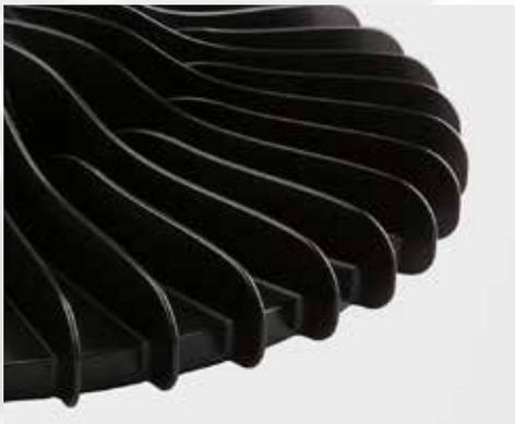
Durch die Erwärmung des Strahlers steigt die warme Luft empor und zieht kalte Luft von unten nach. Dieser Kamineffekt wird beim abalight LED Highbay **SUN** besonders ausgenutzt, indem wir die Rippen bewusst in diesen Luftstrom setzen und dadurch für eine optimale Kühlung der Leuchte sorgen. Ein Weiteres Plus ist das Gehäuse aus Aluminiumdruckguss, das besonders gut geeignet ist, die Temperaturen aus dem Gehäuse nach außen abzugeben.
