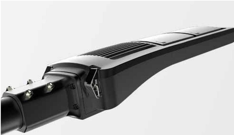
Modulare LED Straßenleuchte mit besonders effizienter Lichtverteilung, Aluminiumgehäuse, modularer Aufbau ermöglicht Austausch einzelner Komponenten, für Mast-Aufsatz und Mast-Ansatz-Montage bei Mast-Durchmesser Ø 60 mm (Zopfmaß),
