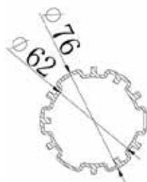
Abmessungen Reduzierung (Art.-Nr. 18975)
