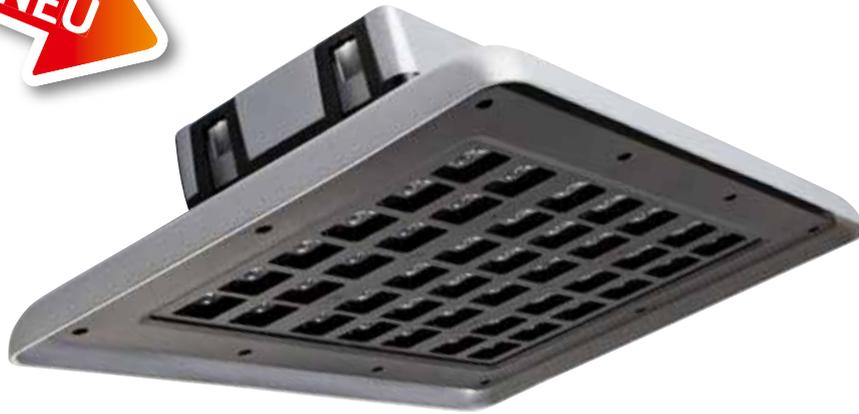
Kompakter LED Highbay aus Aluminiumdruckguss, passive Kühlung, Abstrahlwinkel 80° und 110° durch hochwertige Optiken, Schutzart IP 65, Schlagfestigkeit IK 10, bewährte Meanwell-Treiber-Technologie, dimmbar per 1-10V oder DALI auf Anfrage, UGR <19, mit verschiedenen Leistungsaufnahmen und Farbtemperaturen.
