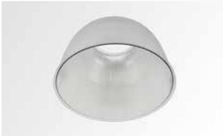
Refraktor HWW 65° (18993), Ø 410 x H 270 mm, transluzent, (UGR 16,5 bei 100 W, UGR 17,7 bei 150W)
