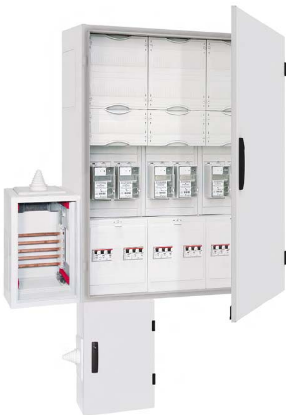
Einspeisegehäuse TZ622 zum Anbau unten oder TZ623 mit Sammelschienensystem CU 12 x 5 mm, 5-polig zur seitlichen Einspeisung rechts oder links am TG...SZ-Zäblerschrank. (Sammelschienenanschlussklemmen Zubehör)
