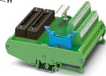
Übergabemodule für analoge I/O-Baugruppen
