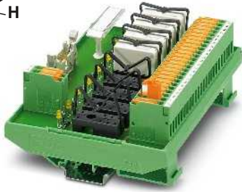
Ausgabemodul für 8 Miniaturrelais mit Messertrennklemmen, 1 Wechsler
