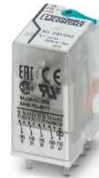
4-Wechsler-Industrirelais (Bipolar) mit Handbetätigung, max. 4 x 6 A
