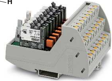
Ausgabemodul mit 8 Miniaturrelais, 1 Wechsler und Sicherung je Ausgangskreis
