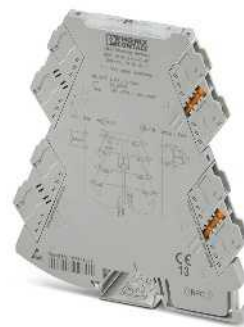
3-Wege-Trennverstärker mit festen Signalkombinationen
