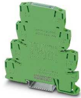
Eingabe-Solid-State-Relais mit TTL (5 V)-Ausgang
