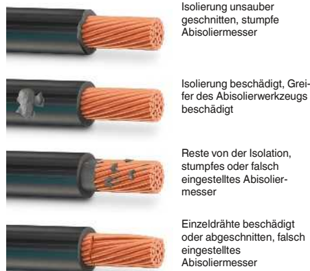
Abisolierfehler nach DIN IEC 60352-2
