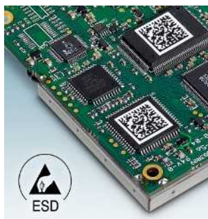
Gerätemarkierung zum Aufkleben, für ESD-Anwendungen, zur Bedruckung mit Thermotransfer-Rolldrucker EML-ESD... Seite 340
