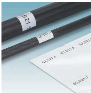
Selbstklebende Leitermarkierung mit trans- parenter Schutzfolie, zur Bedruckung mit Thermotransfer-Rollendrucker WML... Seite 224 WML-HF... Seite 226
