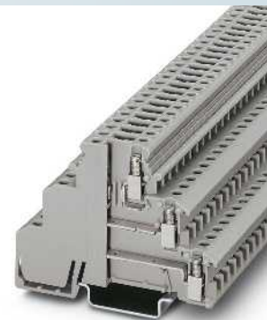
2,5 (4) mm 2 , 15 A, Dreistockklemme mit Trennzone
