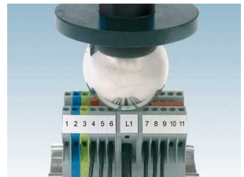
Prüfkugel mit Durchmesser 50 mm
