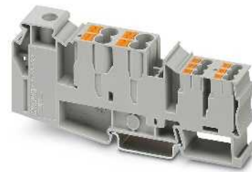
105 A, Potenzialsammelklemme, 4 Eingänge 6 mm 2 , 6 Eingänge 2,5 mm 2
