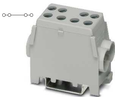
25 (35) mm 2 , 125 A, Hauptleitungs-Abzweigungsklemme, 2 Abgänge 25 mm 2
