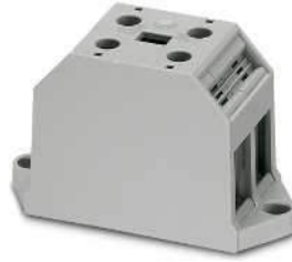
35 (35) mm 2 , 125 A, Klemmenblock, 2-polig
