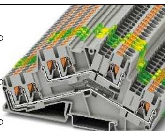
24 A, Doppelstockklemme, 3 Anschlüsse je Etage
