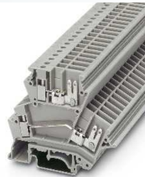
4 (4) mm 2 , 20 A, Doppelstockklemme mit Schraub- und Flachsteckanschluss
