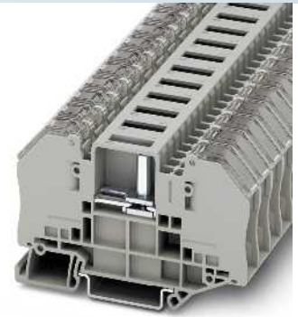
41 A, Messwandler-Trennklemme, mit transparenter Berührungsschutzhaube
