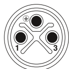
Polbild M12-Stecker, 2-polig+PE, S-kodiert, Ansicht Stiftseite
