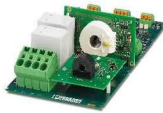
AC-Ladesteuerung Basic NAR, Leiterplatte, Ladefall C, Level 2
