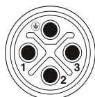
Polbild M12-Stecker, 3-polig+PE, S-kodiert, Ansicht Stiftseite
