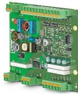
AC-Ladesteuerung Basic, Leiterplatte, Ladefall B, mit MSTB-Anschluss
