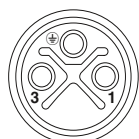
Polbild Buchse M12, 2-polig+PE, S-kodiert, Ansicht Buchsenseite
