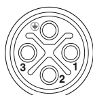
Polbild M12-Buchse, 3-polig+PE, S-kodiert, Ansicht Buchsenseite
