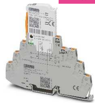
Doppelader (Loop), erdpotenzialfrei, Anschluss 3/6 direkt geerdet, mit Messertrennung, z. B. für 4 ... 20 mA Stromschleife
