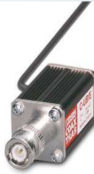
Für Video-Systeme, Schirm erdpotenzialfrei, Grobenschutz, Anschluss: BNC
