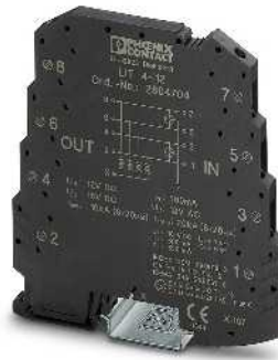
4-Leiter, erdpotenzialfrei, impedanzfrei, z. B. für Temperaturmessung
