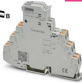
Sende- und Empfangsmodul zur Fernmeldung von TTC-6...-I Produkten
