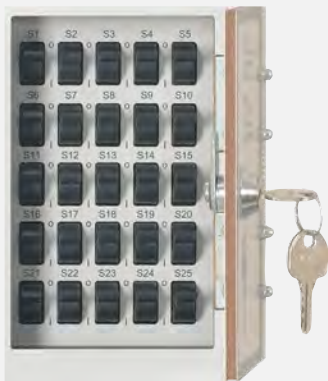
Fehlersimulator mit 25 Fehlermöglichkeiten über Schalter
