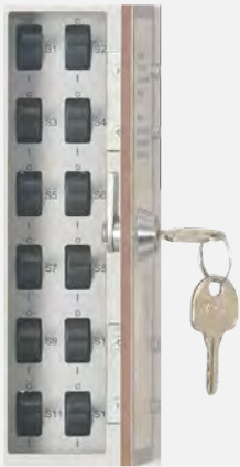
Fehlersimulator mit 12 Fehlermöglichkeiten über Schalter
