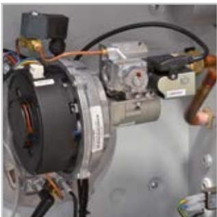
Hohe Energieeffizienz durch modulierenden Gasbrenner
