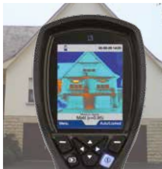
FLIR i3, Temperatur an 3600 Punkten
