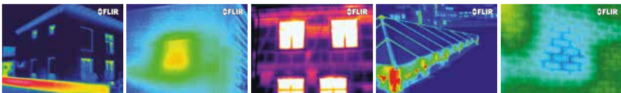
Das Wärmebild zeigt die Dämmungsqualität eines Niedrigenergiehauses.
