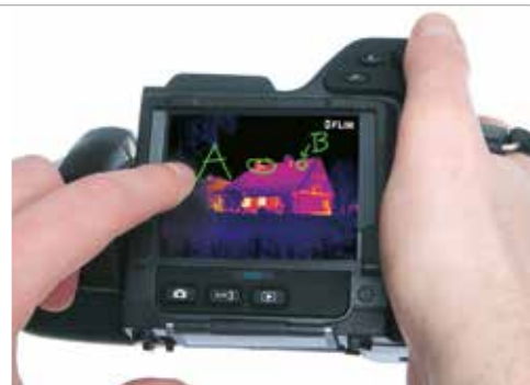
Wärmebild desselben Gebäudes, jetzt mit der MSX-Funktion. Beachten Sie, dass jetzt mehr Details sichtbar sind. Dadurch lassen sich Lüftungsgitter einfacher lokalisieren und die Backsteinstruktur erkennen. Die MSX-Funktion verleiht dem Wärmebild mehr Tiefe.
