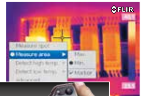
Multifunktionaler LCD-Touchscreen ermöglicht Skizzieren und Markieren direkt auf dem Bildschirm.
