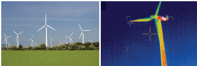
Ein vom Boden aus aufgenommenes Wärmebild einer Windturbinen
