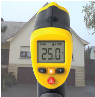
IR-Thermometer, Temperaturmessung an einem Punkt
