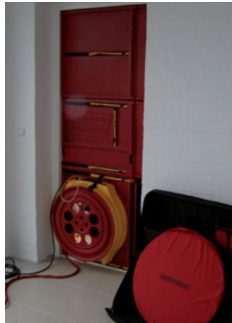
Die "BlowerDoor"-Ausrüstung wird normalerweise in der Eingangstür angebracht.
