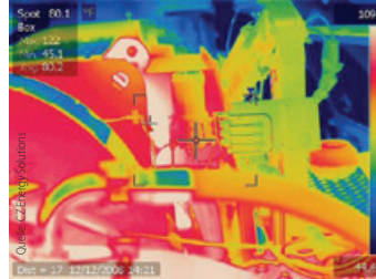
Inspektion des Getriebes einer Windturbine mit einer Wärmebildkamera. Diese Inspektion wurde in einer Höhe von rund 50 m ausgeführt.
