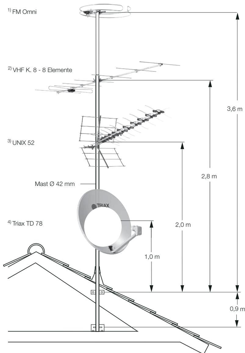
Bei bestimmten Montagevoraussetzungen sind die dadurch erhöhten Windlasten gemäß DIN 1055 Teil 4/2005-03 bzw. DIN 4131 zu berücksichtigen.
