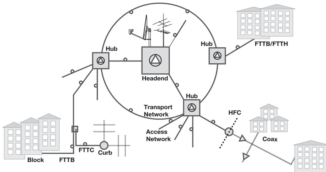
Bei einer HFC-Verbundlösung (Hybrid Fibre Coax) lässt sich alles in einem gemeinsamen Kopfstellensystem kombinieren. Das System kann von einer zentralen Stelle aus installiert, betrieben und gewartet werden; die optischen Transmitter, die Empfänger und das passive Glasfaserkabel gewährleisten die stabile Verbindung zur 'letzten Meile' mit koaxialer Verteiltechnik.
