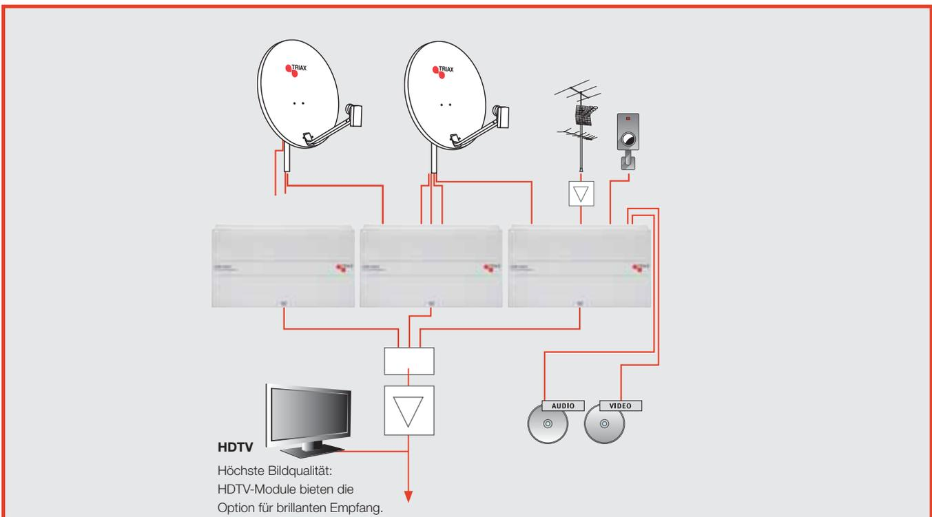
Anlagenbeispiel mit 3 x CSE 3300 zum Empfang von 2 Satelliten. Empfangsbereit für alle Sat- und terrestrischen Signale: DVB-C, Digital-Sat (DVB-S/S2) und COFDM.
