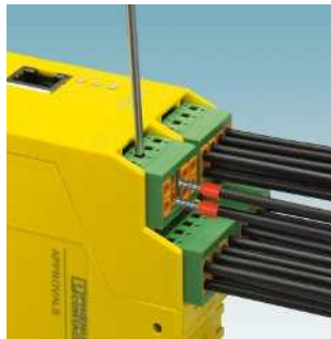
TWIN-Stecker mit Push-in-Federanschluss, Raster 5,0 mm, zur Potentialverteilung TVFKC 1,5/...-ST-5,0 Seite 282
