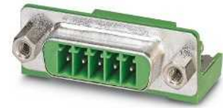
Geschirmte POWER SUBCON-Grundgehäuse für Wandstärken bis 4,5 mm, Befestigungsgewinde 4-40 UNC, mit voreilemndem mittleren PE-Kontakt
