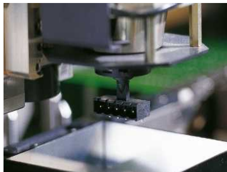
Kamera-Erfassung zur Bauteil-Vermessung
