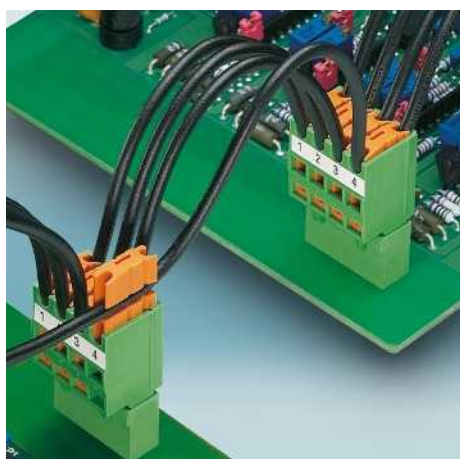
TWIN-Stecker QC 1-BUS mit Schneidanschluss im Raster 5,0 mm
