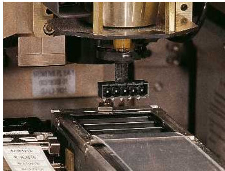
„Pick“ des Bauteils aus dem Gurt
