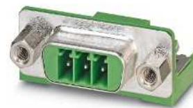
Geschirmte POWER SUBCON-Grundgehäuse, für Wandstärken bis 4,5 mm, Befestigungsgewinde 4-40 UNC
