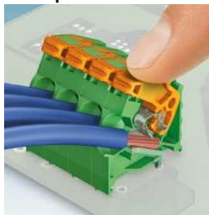
PLH 5-Serie: Push-Lock-Federanschluss, Raster 7,5 mm, bis 41 A Anschluss: 30° zur Leiterplatte PLA 5... Seite 470
