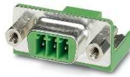
Geschirmte POWER SUBCON-Grundgehäuse für Wandstärken bis 4,5 mm, Befestigungsgewinde 4-40 UNC mit voreilemndem mittleren PE-Kontakt
